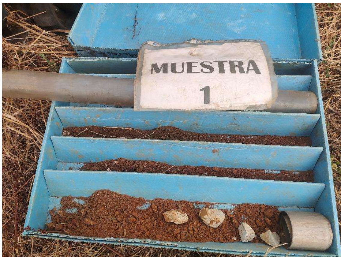
Fotografía n° 4: Muestra recogida en DPSH-2 (0,00 – 1,20 m).
